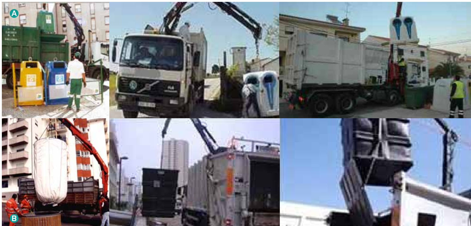
Fig. 6 Exemplos de recolha de ecopontos e sistemas de elevação com grua: A - ecopontos de superfície; B- ecopontos subterrâneos
