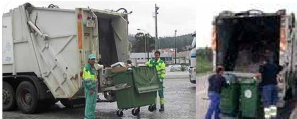
Fig. 7 Carga posterior e sistema de elevação de contentores: A-1.100L; B-240L
