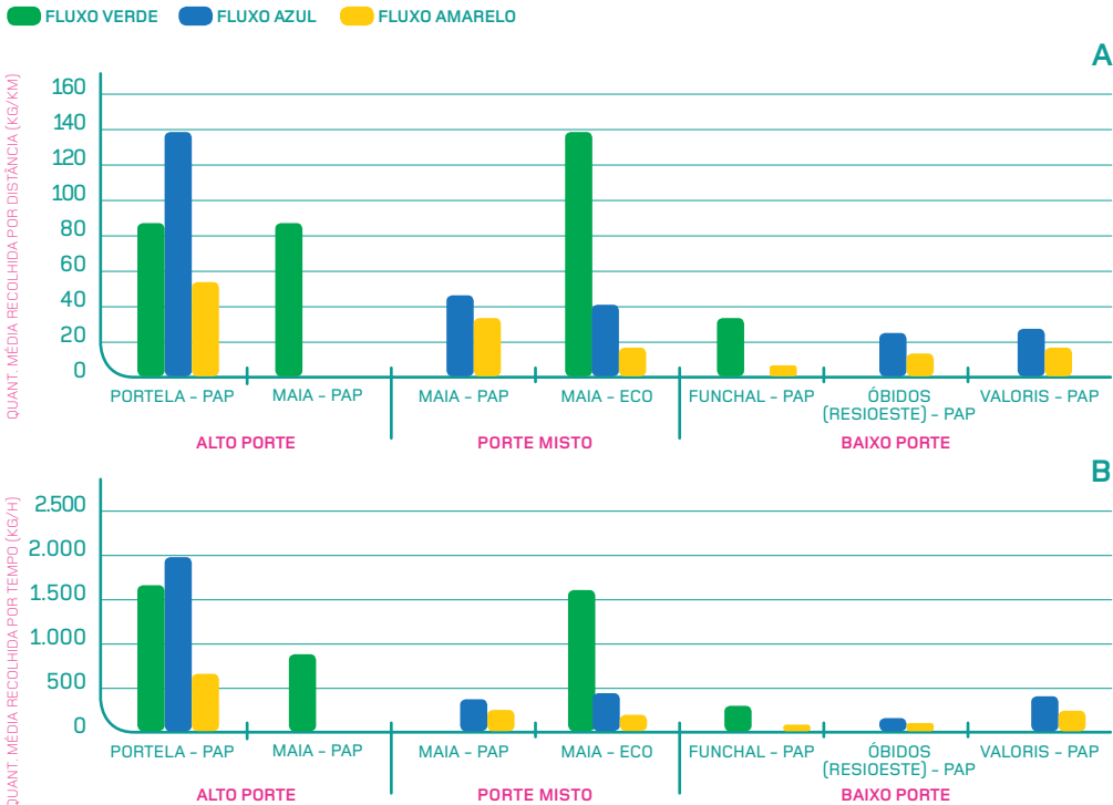
Fig. 37 Comparação de indicadores de recolha para os estudos de caso analisados, agrupados por tipologia de habitação. A: em termos de quantidades recolhidas por unidade distância (kg/km); B: Quantidades recolhidas por unidade de tempo (kg/h).
